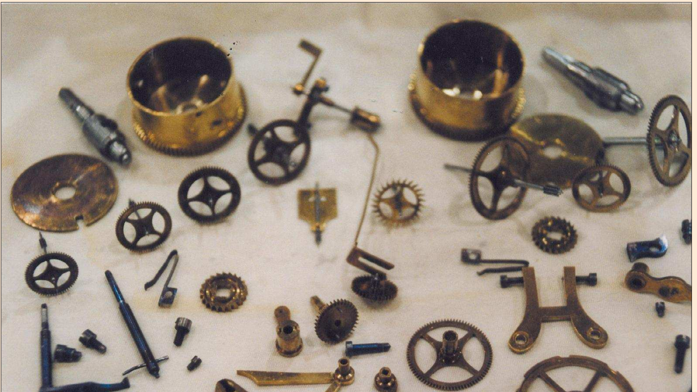
Para la reparación de una máquina 'parís' nuestro primer paso será el desmontaje total de la misma, donde se observa la suciedad, para proceder a su limpieza mediante bencina
