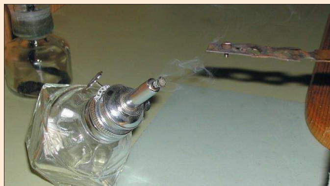
Detalle de cómo podemos azular con calor las cabezas de los tornillos con la lamparilla
