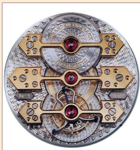
Turbillón Girard Perregaux, famoso por sus tres puentes
