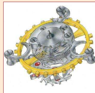
Dibujo del turbillón de la casa Lanche
