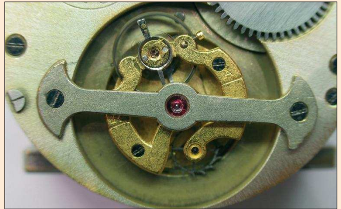
En su movimiento, la iaula del turbillón realiza un giro completo de 360 grados
