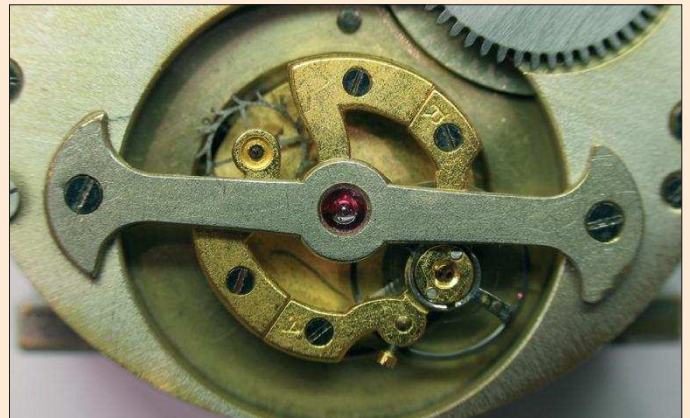
Cuando está abajo el volante, el reloj adelanta con lo que se autorregula la marcha
