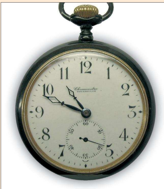
Vista del reloj de bolsillo una vez restaurada la esfera, agujas y caja
