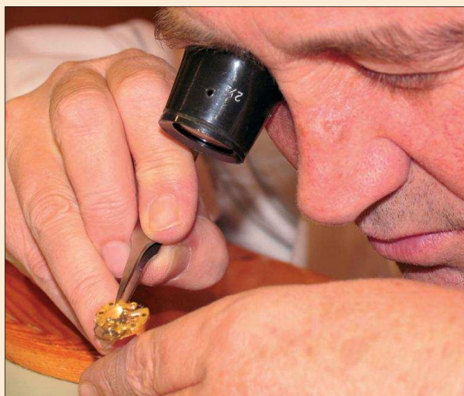
El desmontaje de un turbillón requiere una gran experiencia y maestría en la profesión
