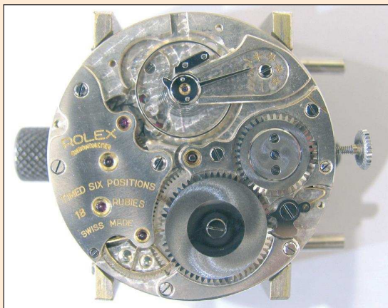
Visa de la maquinaria, donde se aprecian los tres puentes
