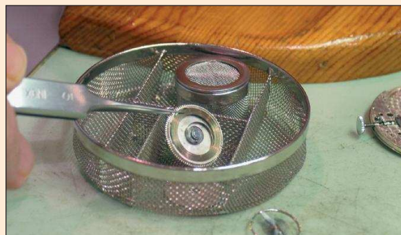
Procederemos a introducir todas las piezas en el cestillo de limpieza, separándolas gracias a los compartimentos para facilitar de esta manera su posterior montaje
