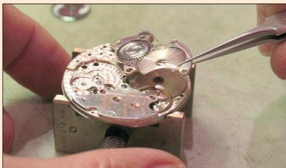
Proceso de desmontaje del movimiento. En la fotografía podemos apreciar el desmontaje del puente de cubo
