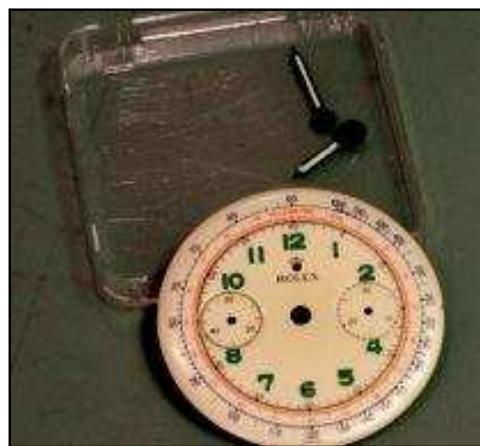
◆ Esfera y agujas totalmente restauradas. éstas últimas va con material luminiscente. La esfera ha recuperado sus colores originales
