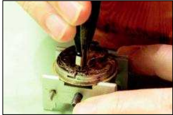
◆ Detalle del proceso de desmontaje de la rueda de arrastre, pieza perteneciente al módulo del cronógrafo
