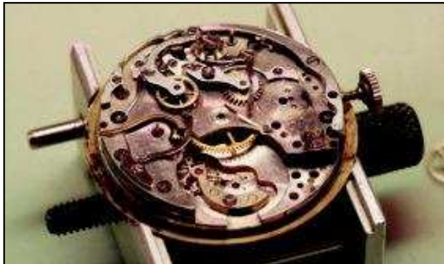
◆ Mecanismo del reloj desmontado. sin volante y sin las piezas del módulo de cronógrafo
