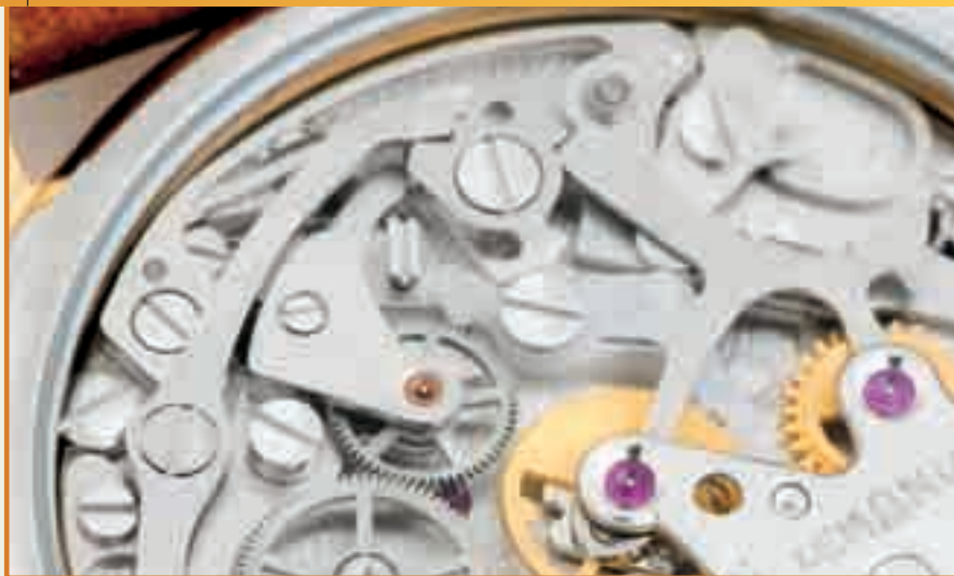
◆ Calibre manual base ETA 6497 del modelo Aviador
