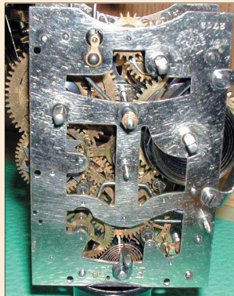
Vista de la platina anterior de la maquinaria, ya limpiada. Todos los elementos de la máquina deben ser limpiados. El líado y bulido de las platinas se observa en esta imagen.
