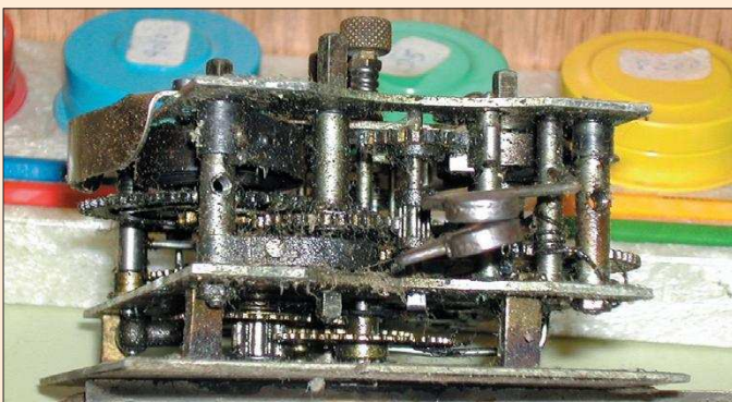
Detalle del estado de la máquina, se aprecia con claridad la suciedad a eliminar
