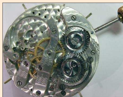
Vista de la máquina una vez limpia y engrasada
